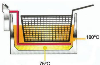
**Technologie zone froide :** la zone située sous la résistance chauffante étant environ deux fois moins chaude, les résidus s'y déposent par décantation naturelle et l'huile de cuisson reste ainsi plus propre plus longtemps. Cela évite les mélanges de goûts et permet d'utiliser l'huile plus longtemps.
