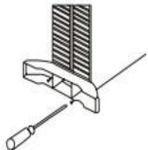
Ceux-ci doivent être fixés à la base du radiateur à l'aide des 4 vis auto-taraudeuses fournies, en veillant à ce qu'elles soient correctement positionnées dans les extrémités inférieures des moulures latérales du radiateur.
